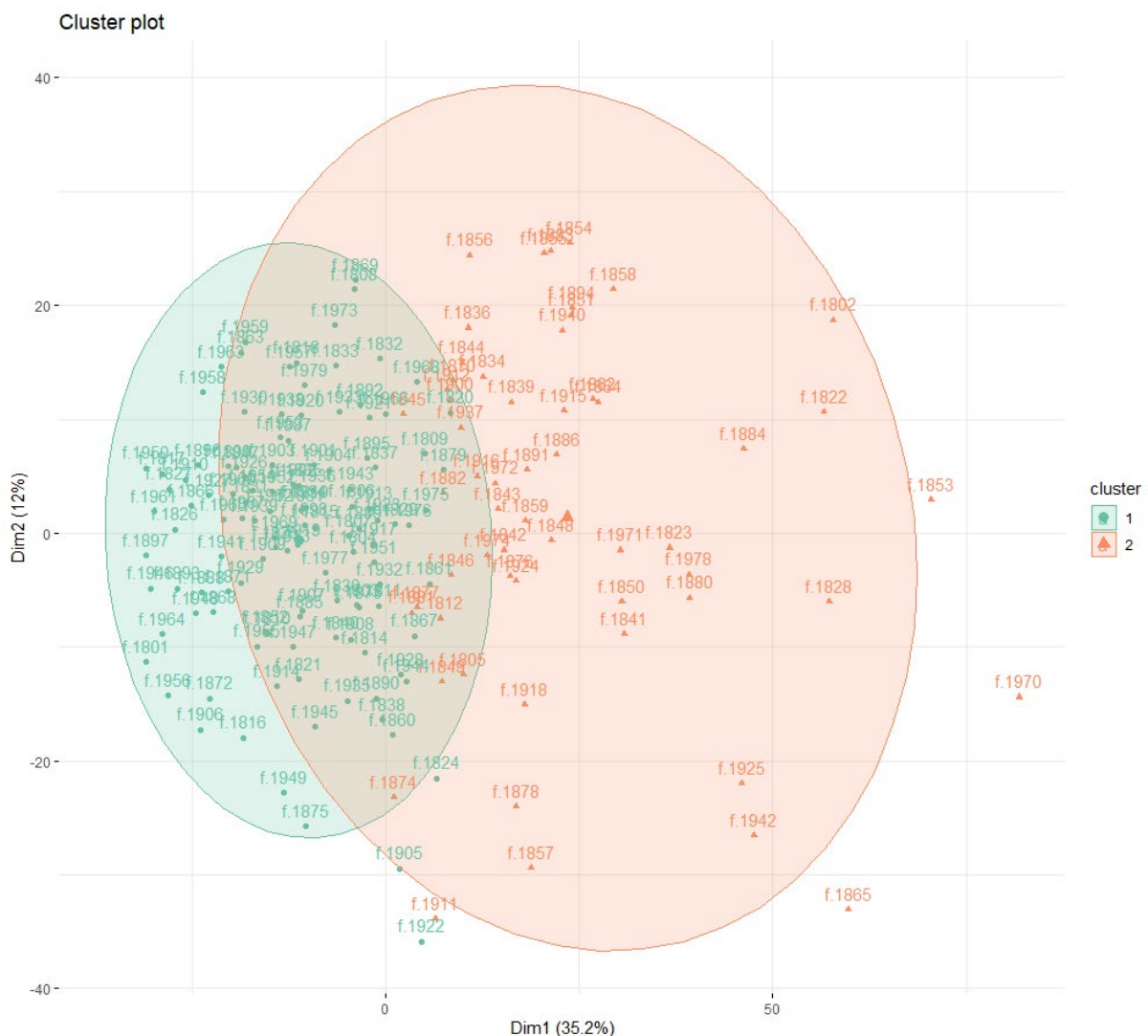
Figura 14: Risultato del raggruppamento dei dati tramite CA, algoritmo k-means. I vari target sono rappresentati dalla lettera 'f' seguita da un numero.
